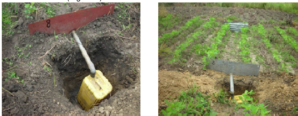
Figure 1. Dispositif de collecte des eaux de ruissellement
